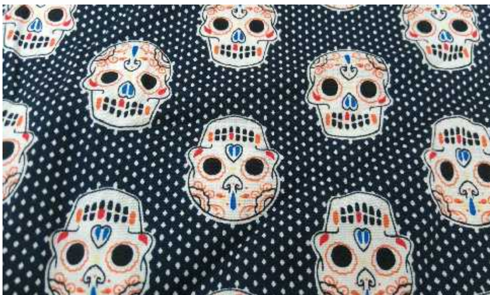
Gambar 3.1 Kain hasil pencapan yang tidak terdapat cacat blobor
