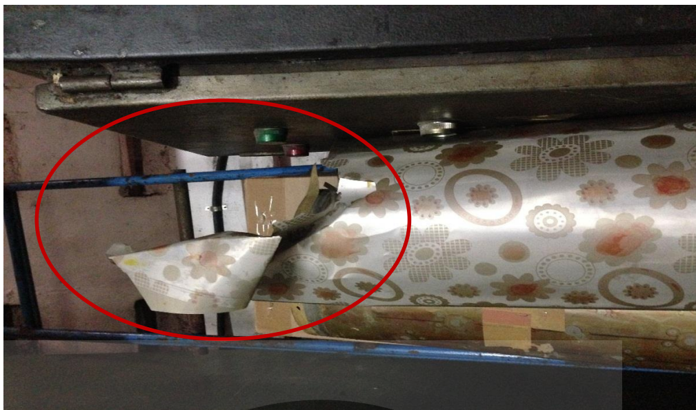
Gambar 3.2 Screen yang sobek pada saat produksi
