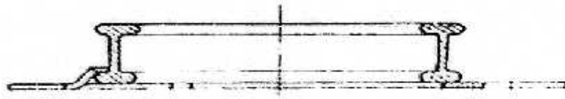
Gambar 1.1 Bentuk Penampang Melintang Ring flange
