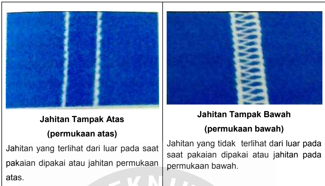
Gambar 2.5 Jahitan Kelas 600 pada Mesin Covering Chainstitch dengan 2 jarum
