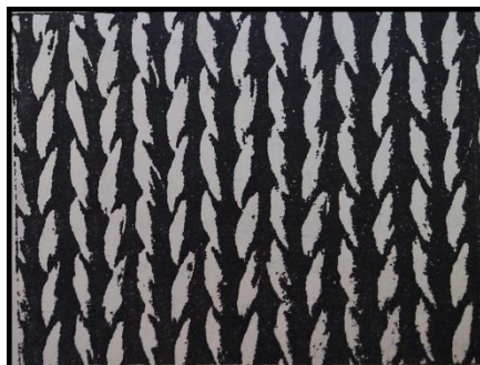
Gambar 2.1 Struktur Jeratan Kanan Rajut Polos
