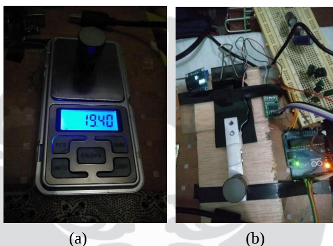
Gambar IV. 8 Proses kalibrasi loadcell sensor; (a) Hasil penimbangan bobot beban dengan menggunakan perangkat timbangan neraca digital; (b) bobot beban pada loadcell sensor
