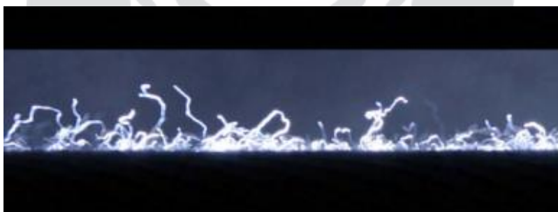
Gambar II. 24 Profil fuzziness/hairiness pada benang spun
