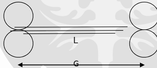
Gambar 2.9 Jarak Jepit Roll dengan Panjang Staple yang Lebih Pendek
