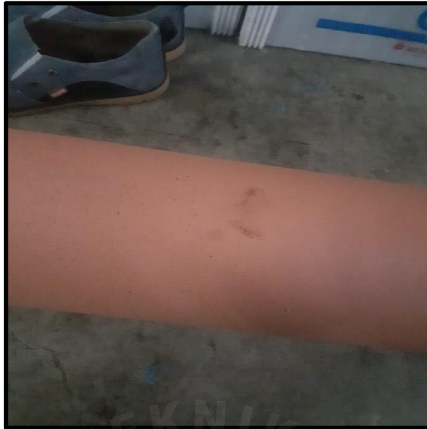
Gambar 1.1 Lapisan roll take up yang sudah aus
