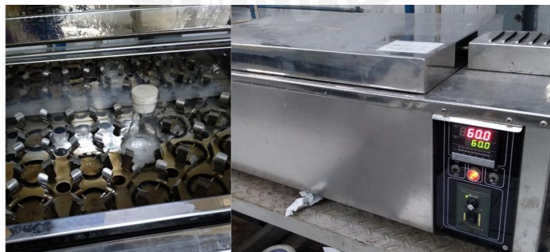
Gambar L4. 3 Mesin Waterbath untuk proses heating pengganti Mesin Steamer Box
