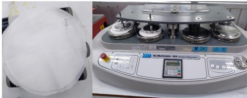
Gambar L4. 6 Mesin Martindale untuk uji pilling standar ISO PT Argo Manunggal Triasta
