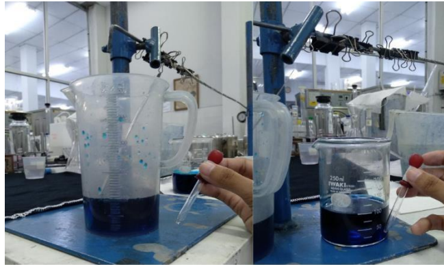
Gambar L4. 4 Larutan untuk uji tetes menggunakan zat warna remazol turquoise blue untuk memudahkan pengamatan daya serap kain
