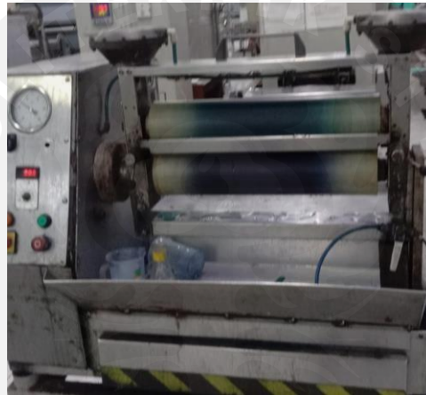
Gambar L4. 2 Mesin Padder skala Laboratorium PT Argo Manunggal Triasta
